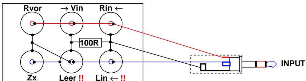
**!! Nur zum Verpolungs-Test! Bei der Messung muss Lin ← in die Leer-Buchse gesteckt werden!**
