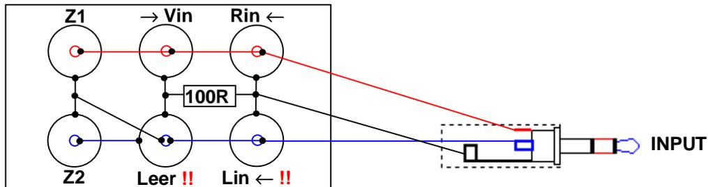
**!! Nur zum Verpolungs-Test! Bei der Messung muss Lin ← in die Leer-Buchse gesteckt werden!**
